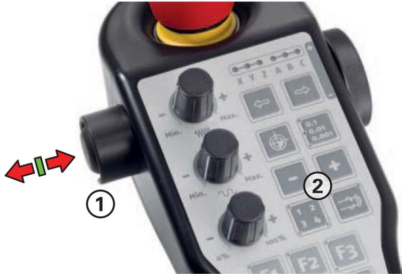
Fig. 2-2 : Position du bouton de confirmation sur la commande manuelle
