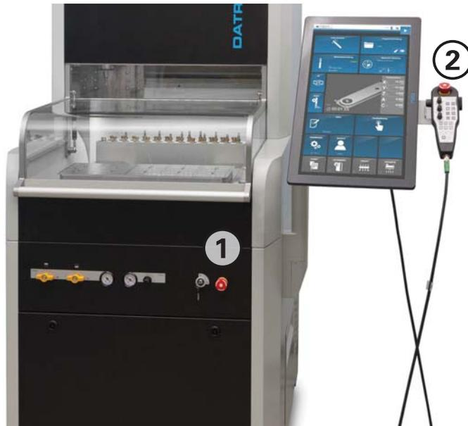
Fig. 2-1 : Positions des boutons d'ARRÊT d'URGENCE sur la machine
