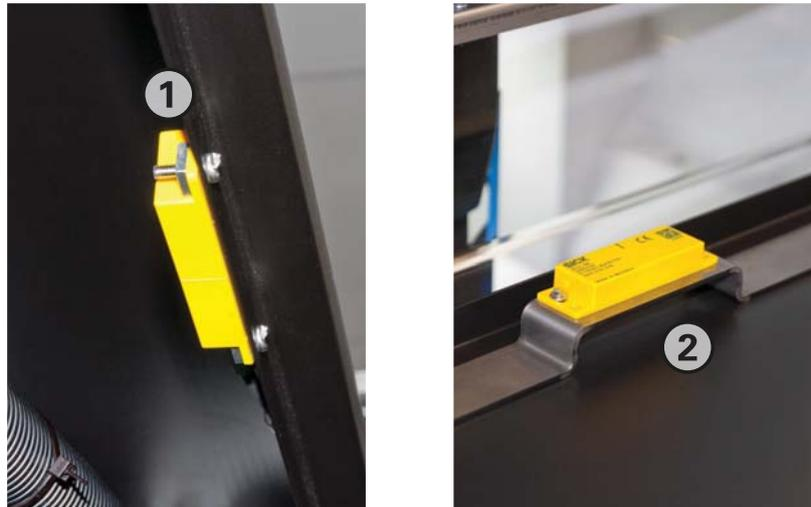
Fig. 2-5 : Interrupteur magnétique pour surveillance de la trappe avant du haut
